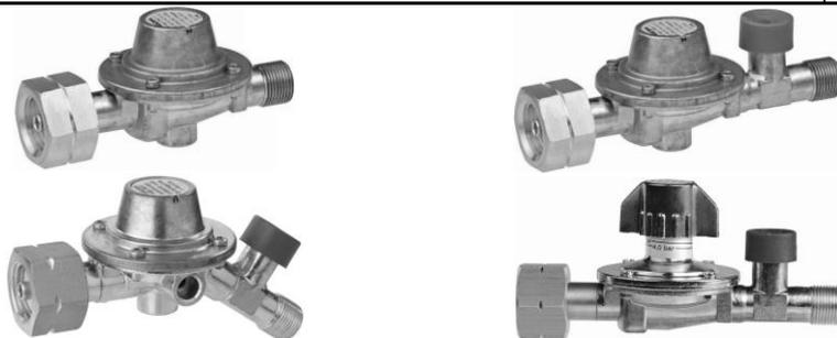
Регулятор давления постоянно поддерживает заданное выходное давление – у регулируемых регуляторов в диапазоне заданных значений – независимо от колебаний выходного давления (например, давления в баллоне) и изменений расхода и температуры в установленных границах. Регулятор давления может быть оснащён устройствами безопасности опционально.
