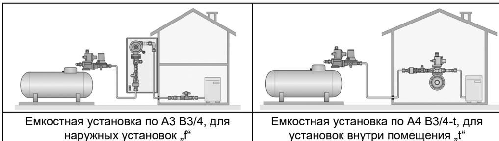
Емкостная установка по А3 V3/4, для наружных установок „f“
