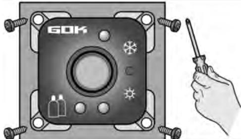
7. Montera manöverpanelen. Passa in frontskivan tillsammans med skyddsdosan i urtaget exakt och fäst i väggen med hjälp av fyra skruvar.
