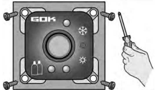
7. Das Bedienpanel montieren.
