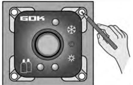
2. De inbouwplek van het bedieningspaneel zoveel mogelijk op een goed zichtbare en toegankelijke plaats en op een recht en glad oppervlak kiezen; hiervoor een uitsparing met Ø 55 mm maken. Dragende delen in de wand om veiligheidsredenen mijden.
